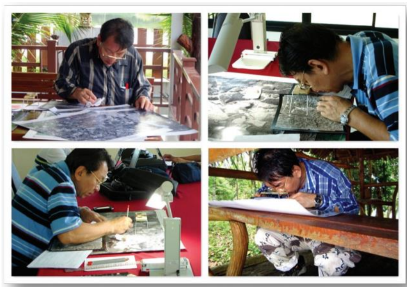
ภาพที่ ๓.๔๒ การอ่าน แปล ตีความ และวิเคราะห์ภาพถ่ายทางอากาศด้วยกล้องมองภาพสามมิติ
